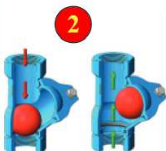
Sprzdż kierunek przepływu na zaworze zwrotnym kulowym
