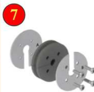
Przepust kablowy umożliwia montaż przewodu bez obcinania wtyczki
